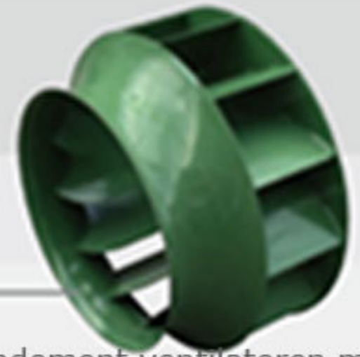
Hoog rendement ventilatoren met achter- waarts gebogen schoepen, directe riem- vrije aandrijving en koperen bescherming- ring ATEX Turbines "haut rendement" à réaction coaxiale ; Entraînement direct sans cour- roie avec anneau en cuivre correspondant aux normes ATEX
