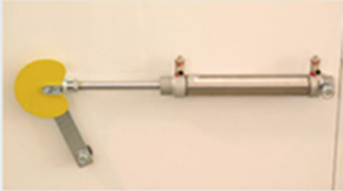
Elektrapneumatische bediening spuiten - drogen Commande électropneumatique pistorage - séchage
